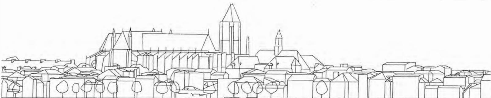
14/Rocamadour (Francia) - Particolare di un alzato d'insieme a scala 1:500 del borgo visto da est mediante stereofotogrammetria aerea completata, per le facciate del complesso religioso, mediante stereofotogrammetria terrestre, (I.G.N. - Francia per il Ministero incaricato della pianificazione territoriale).
