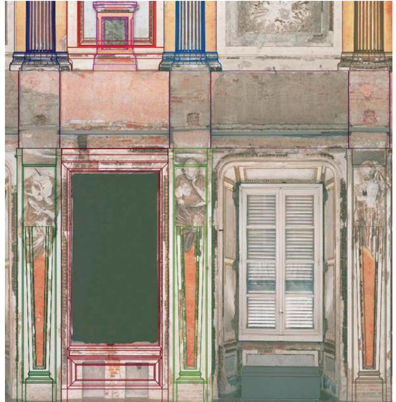
un pixel ogni 3,35 millimetri; ciò consente una modellazione con una tolleranza di 4 millimetri. Operativamente il processo consiste in: estrazione di profili 3D; creazione di superfici tra i profili; inserzione delle deformazioni sovrainposte nel tempo tramite modifica delle curve isoparametriche e punti di controllo.
