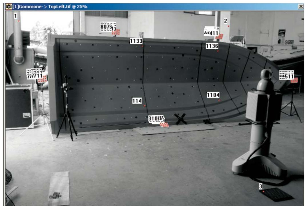
15/ Comparazione tra il modello *gold standard* la prima mesh allineata col solo metodo ICP e la seconda mesh ottenuta fondendo l'allineamento ICP guidato dalla fotogrammetria. Nel primo caso è evidente una cospicua discrepanza (7,5 cm) che scende a meno di 0,5 cm nel secondo caso.
