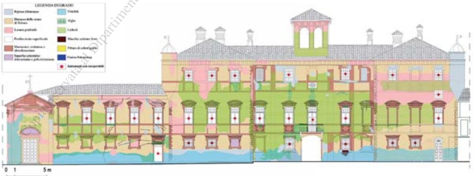
5/ Palazzo Armano, sezione trasversale su corte e corpo di fabbrica principale, con proiezione di griglia metrica in trabucchi piemontesi.
