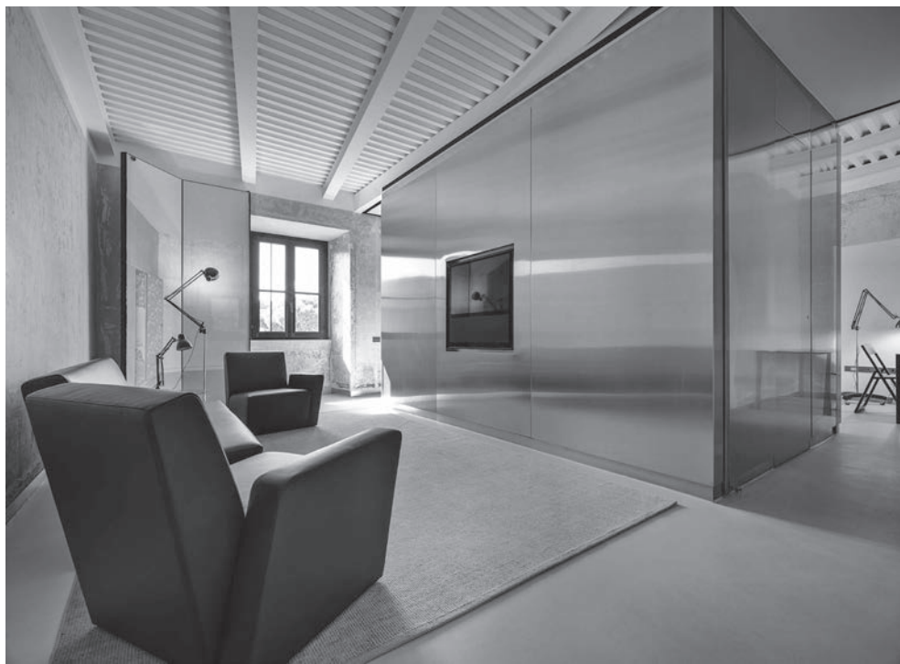
Fig. 9. L'inserimento di volumi in acciaio inox che contengono i servizi costituiscono un 'contrappunto' tecnologico che non interferisce con la percezione dello spazio originario (@Ateliers Jean Nouvel).
