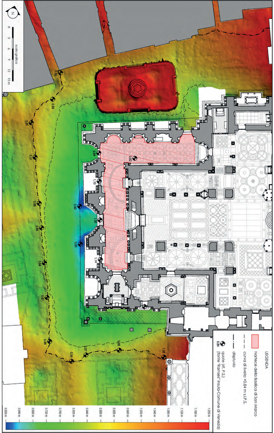
Fig. 5. Le quote sul medio mare delle aree pavimentali circostanti S. Marco. La variazione dei colori rappresenta le quote poste tra 62 cm (blu) e 120 cm (rosso) sul medio mare del mareografo di Punta della Salute.
