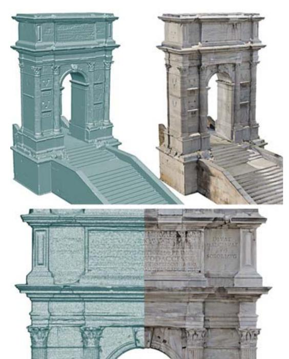
Le immagini da terra e da drone, elaborate con il software fotogrammetrico Agisoft Metashape, hanno generato un modello con un GSD risultante pari a 1,64 mm/px e un errore di riproiezione medio pari a 2,43 px. I dati sono stati quindi integrati in un unico siste-
