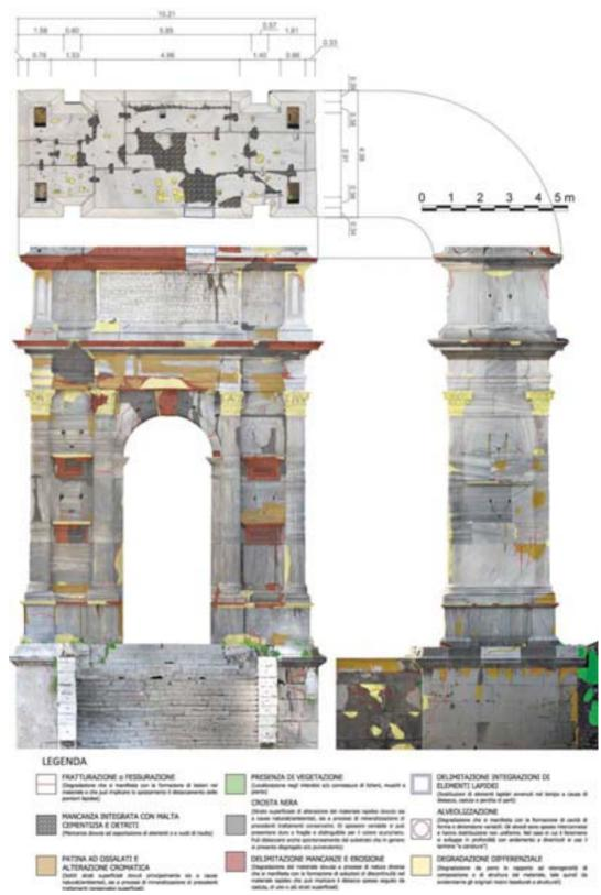
11/ Viste fotografiche di dettaglio in cui è evidente lo stato di deterioramento superficiale dovuto all'erosione del materiale lapideo dell'Arco (foto di Gianni Plescia). Details showing the superficial deterioration due to erosion of the stones of the Arch (photographs by Gianni Plescia). 12/ Schema del processo di creazione del Digital Twin dell'Arco di Traiano (elaborazione degli autori). Diagram showing the method used to create the Digital Twin of the Arch of Trajan (by the authors).
