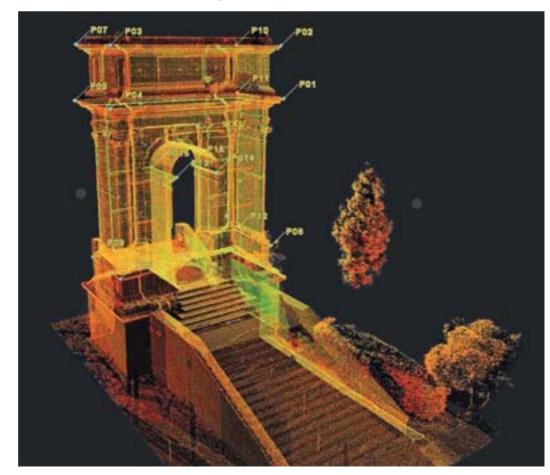
8/ In alto, a sinistra: modello 3D georeferenziato, in visualizzazione solid mesh, ottenuto dall'integrazione dei dati laser scanning e fotogrammetrici (terrestri e aerei); in alto, a destra: modello texturizzato nel software Metashape con gli scatti ad alta risoluzione. In basso, a sinistra: dettaglio della vista ortografica del prospetto frontale in wireframe; in basso a destra: vista texturizzata (elaborazioni di Romina Nespeca).
