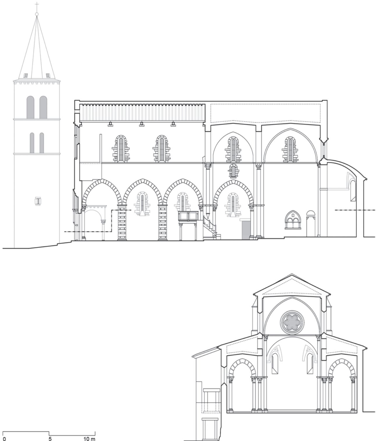
Fig. 3 – Amaseno, Santa Maria Assunta: sezioni longitudinale e trasversale. Nella prima è indicato il piano di sezione/taglio della pianta (elaborazione grafica di E. Gallotta).
