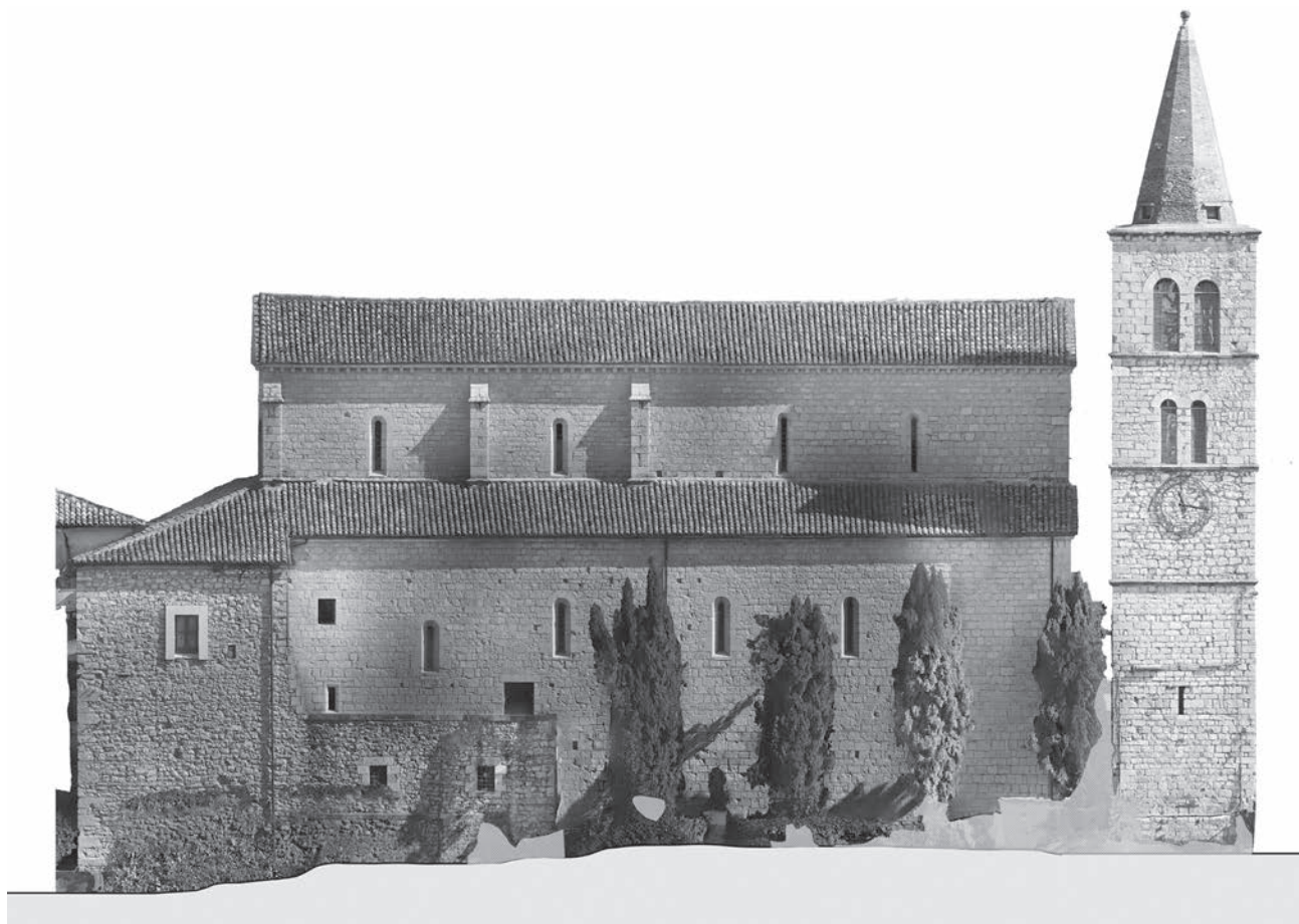
Fig. 9 – Amaseno, Santa Maria Assunta: fianco laterale sinistro. Ortofoto ottenuta integrando i dati forniti da Scanner Laser 3D a differenza di fase Faro Focus 3D con quelli ricavati mediante fotogrammetria digitale (elaborazione grafica di R. Barni).
