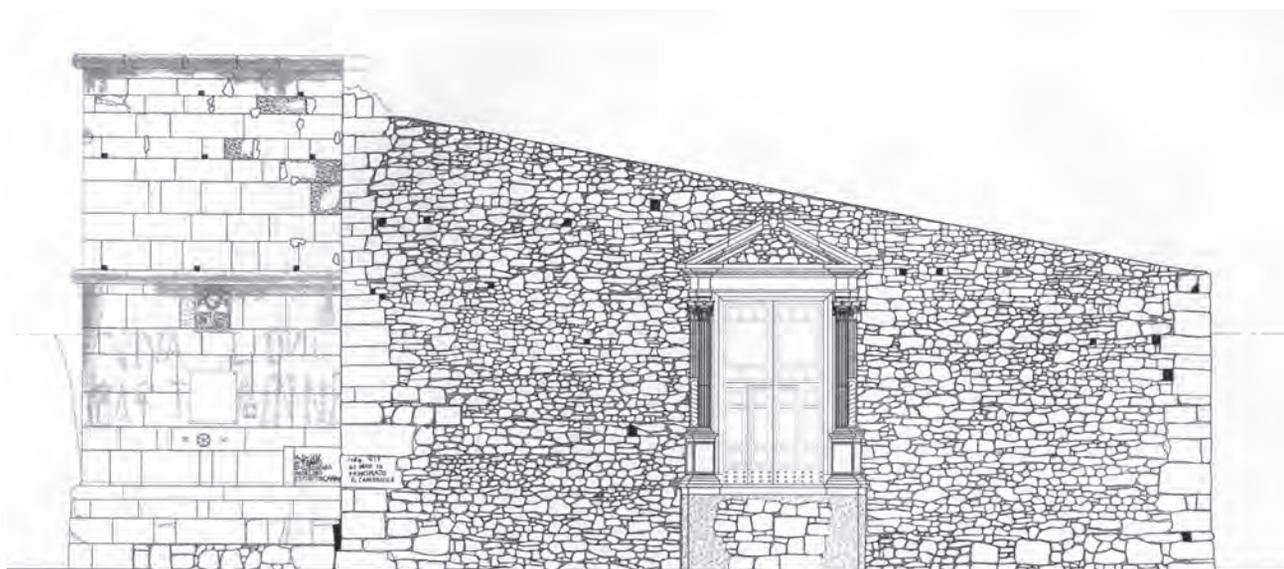
Fig. 6 – Taranta Peligna (Ch), Chiesa di San Biagio, prospetto principale con apparecchio murario in bozze di dimensioni variabili a corsi sub-orizzontali (rilievo A. Lannutti, 2003).
