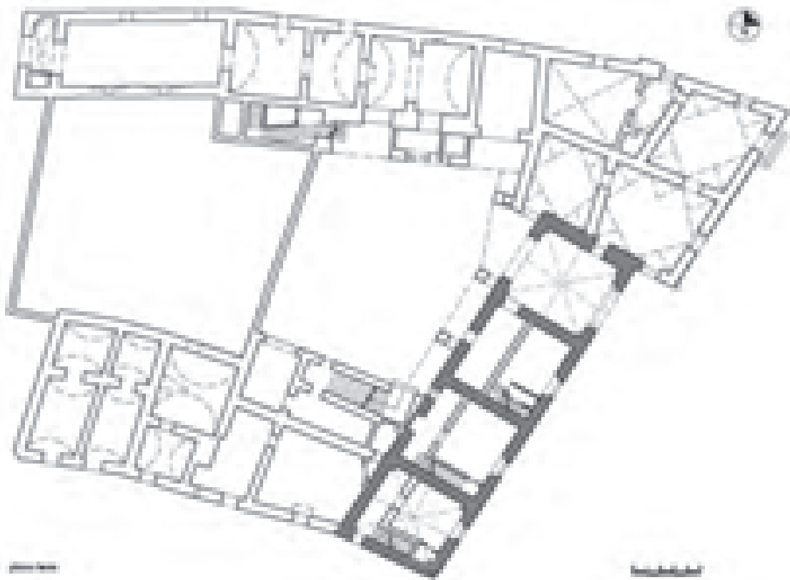
Fig. 4 – Aversa, palazzo del Tufo-Azzolini, in via Santa Marta 70, pianta del piano terra sono campiti in grigio gli ambienti trecenteschi (rilievo dell'autore).
