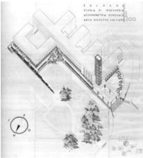
Fig. 2. Veduta assonometrica, 1932. La pensilina d'ingresso, qui concepita come una struttura a impluvio con sottostante vasca per la raccolta delle acque, non ha ancora raggiunto la conformazione poi effettivamente eseguita (da CASCIATO, GRESLERI 2006, p. 69).
