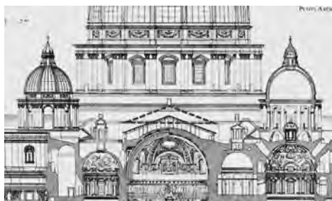
Fig. 3. Sezione trasversale della navata di San Pietro in Vaticano con la struttura di sostegno del tetto a pilastri poggiati sulla volta. Si noti la maggiore quota d'imposta del tetto (sagoma tratteggiata) nell'ipotesi di una incavallatura pensile nella quale la catena orizzontale, abitualmente rialzata dall'estradosso murario per consentire la praticabilità, determina la maggior quota d'imposta (da LETA-ROUILLY 1882, pl. 8).
